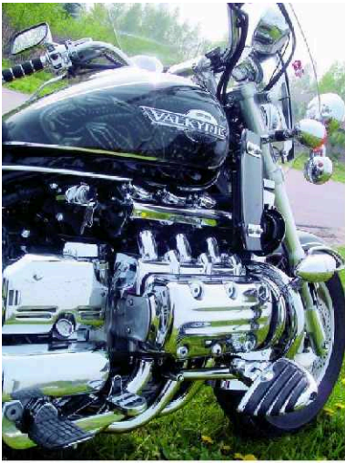
W sześciocylindrowcu F6C napęd wałków rozrządu powierzono paskom zębatym. Zasila go bateria sześciu gaźników
